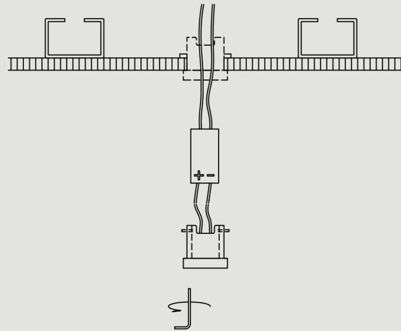
Manchmal ist man kurz entschlossen oder möglichst flexibel. Ein anderes Mal fügt man sich in einen Bestand und freut sich dennoch auf die Entdeckung der Möglichkeiten des SYSTEM DOT 28. Deshalb hat GEORG BECHTER LICHT ein Einbaumodul entwickelt, das auch im Nachhinein einbaubar ist und einen Minitreiber lokal verorten kann.
