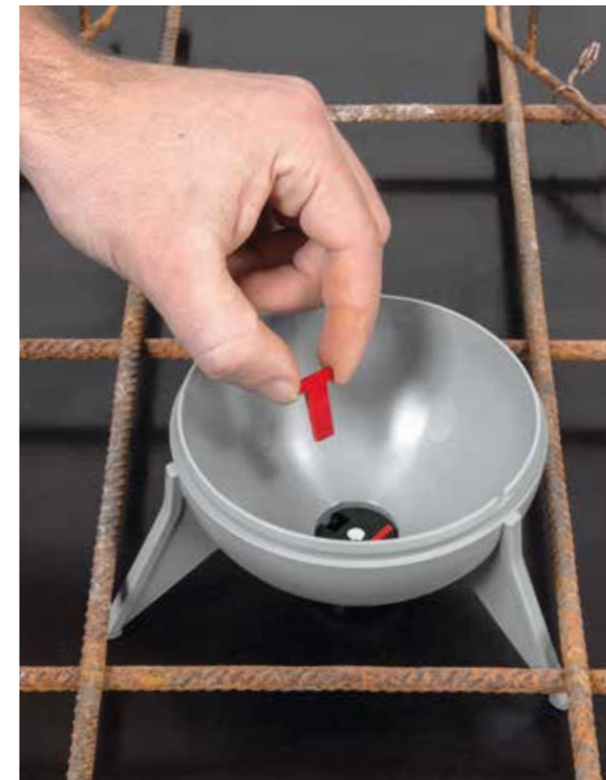
Der Sperrstift verhindern das Aufschwimmen der Kapsel.
