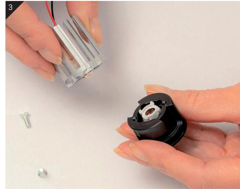
4. Drehen Sie die beiden Schrauben, mit denen die LED-Platine befestigt ist, heraus.
