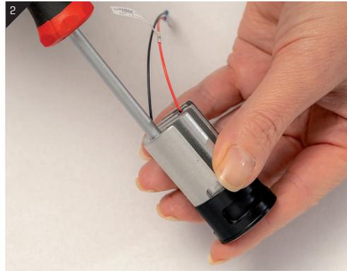
3. Entfernen Sie den Abdeckring und den Reflektor
