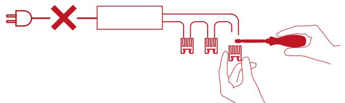
**LEUCHE NICHT UNTER SPANNUNG ANSCHLIESSEN, ABSCHLIESSEN ODER TAUSCHEN!** Bei der Montage und Demontage der Leuchte muss der LED-Treiber mindestens 10-15 Sekunden von der Netzspannung getrennt sein! HOT PLUG führt zu einem direkten Schaden an der LED, welcher nicht unter die Gewährleistung fällt!
