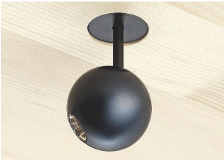
Holz: In Massivholzdecken wird die Holzkapsel von hinten eingefräst. Elektroinstallationen erfolgen somit geschützt. Raumseitig bleibt nur ein Loch von 28mm Durchmesser
