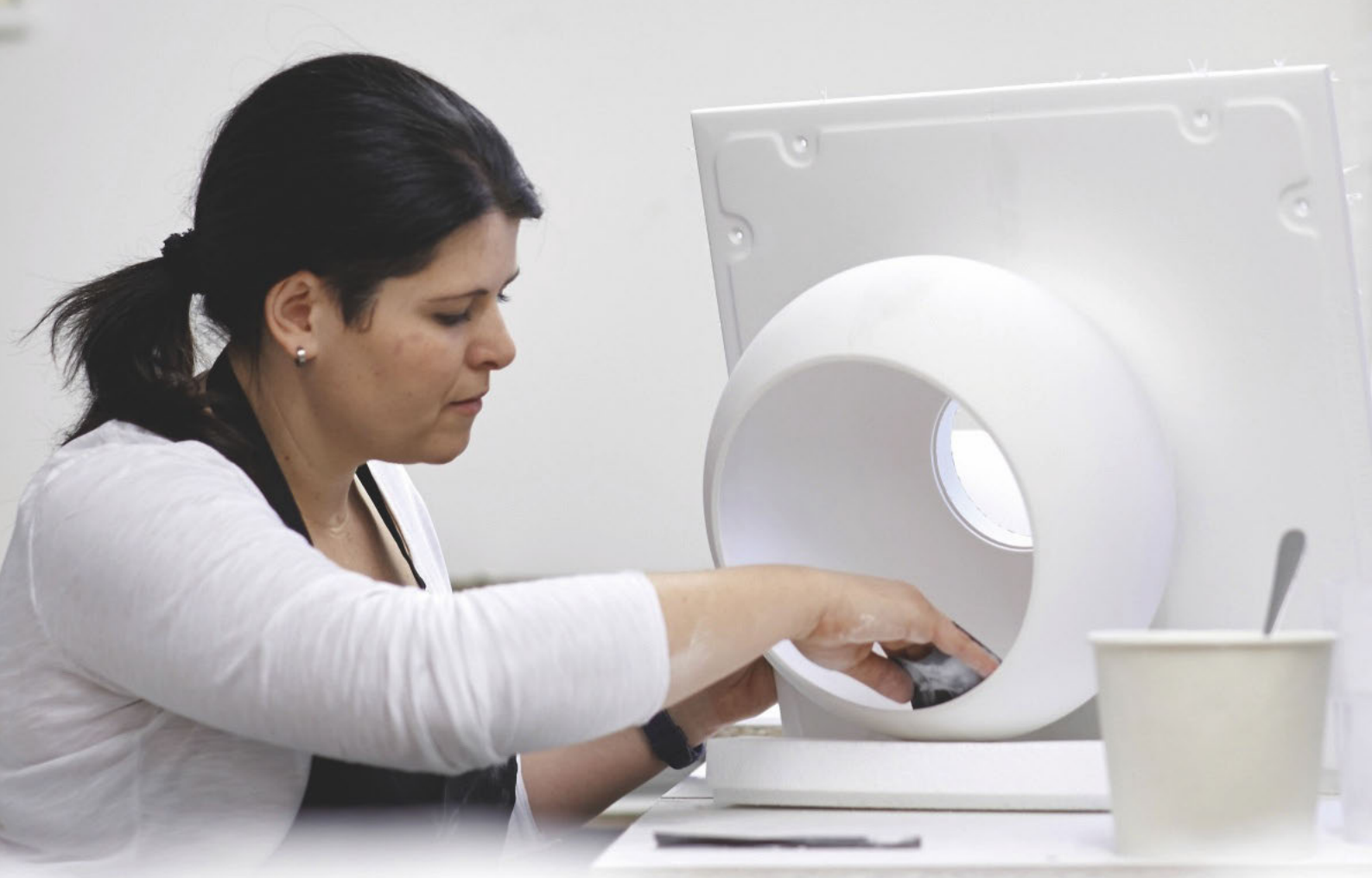
Finish eines gegossenen »Vlobe«-Leuchtenmoduls aus faserverstärktem Gips – abgestimmt auf 12,5 mm Gipskartonplatten
