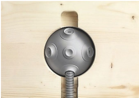
Holz: In Massivholzdecken wird die Holzkapsel von hinten eingefräst. Elektroinstallationen erfolgen somit geschützt. Raumseitig bleibt nur ein Loch von 28mm Durchmesser
